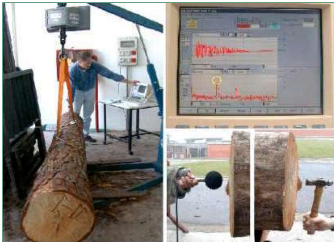
Figura N° 4: Determinación Módulo de Elasticidad mediante FFT Analyzer
