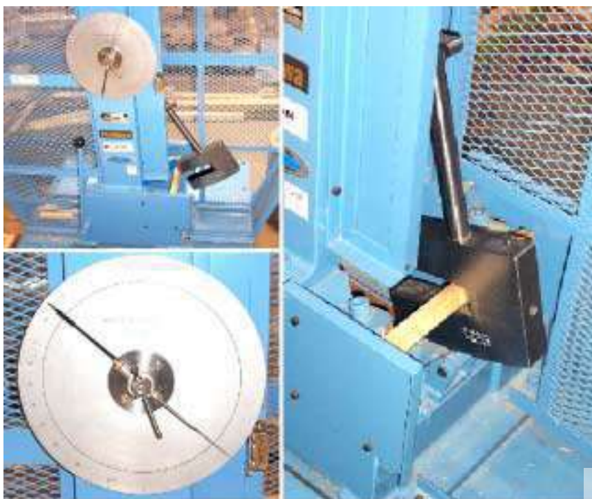
Figura N° 13: Ensayo de Resistencia al Impacto (Flexión Dinámica)
